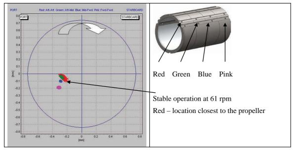
Figure 17 **Steady running ahead – 61 rpm**Slika 17 **Jednolika vožnja pramcem – 61 min**-1
