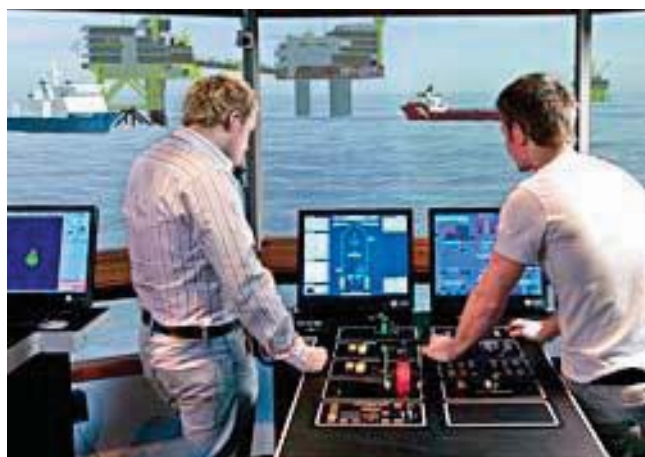
Figure 5 Ship bridge simulator for personnel training Slika 5 Simulator brodskog zapovjedničkog mosta za uvježbavanje osoba
