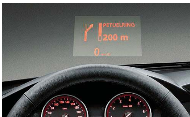
Figure 4 BMW Head-Up display Slika 4 HUD zaslon u BMW vozilu
