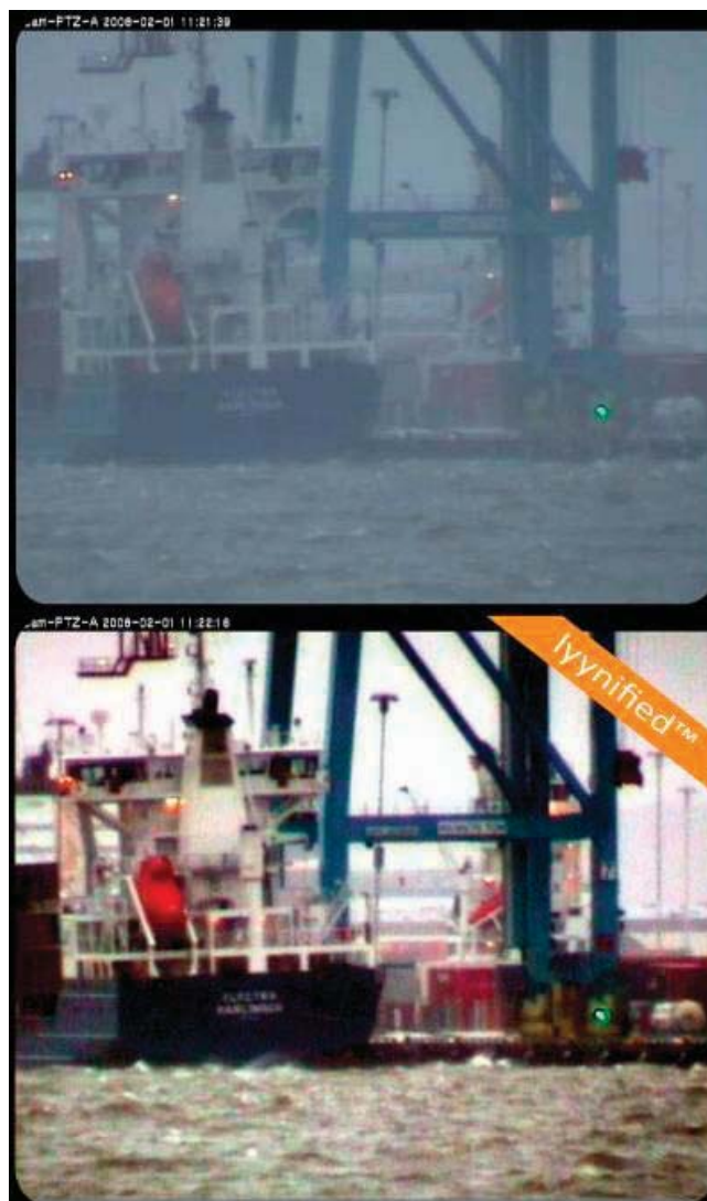
Slika 7 LYYN AR sustav „čisti“ u realnom vremenu video sliku u uvjetima slabe vidljivosti.
