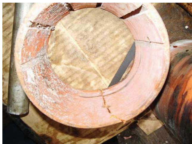
Figure 2 Excessive wastage and crack to a damaged aft shaft strut bearing Slika 2 Nedopušteno velika istrošenost i pukotine oštećenog ležaja stražnjeg osovinskog skroka
