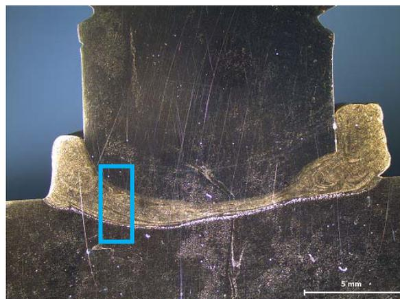
**Fig. 17** Stud macrostructural testing area
