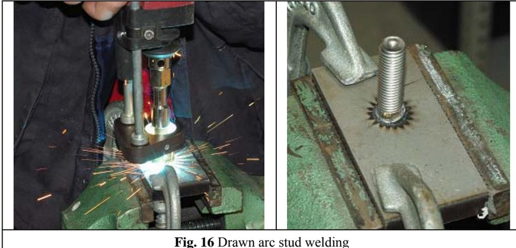
**Fig. 16** Drawn arc stud welding
