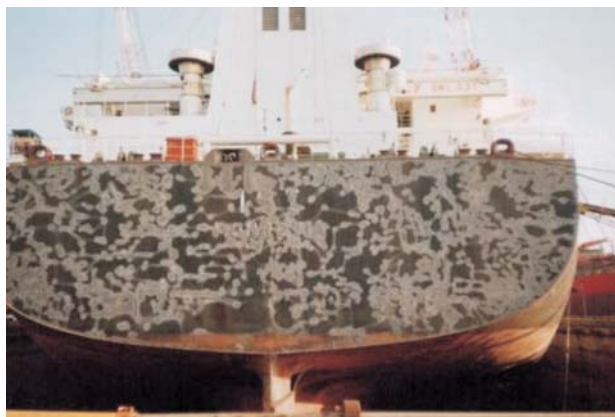
Slika 11 MT Ist, VII. dokiranje; Djelomično pjeskarenje OPB (Sa 2) i popravak AC premaza Figure 11 MT Ist, Docking No VII; Spot sand blasting (Sa 2) and AC touch up coating renewal
