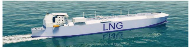
Figure 1A 220 000 m³ LNG carrier designed by STX-FranceSlika 1220 000 m³ LNG (brod za prijevoz ukapljenog plina), projekt brodogradilišta STX France
