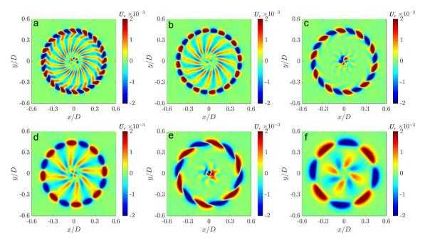
Fig. 17. The first six modes of SPDMD for (a) mode  $1, f/f_{bp}=4$ , (b) mode  $2, f/f_{bp}=3$ , (c) mode  $3, f/f_{bp}=2.5$ , (d) mode  $4, f/f_{bp}=2$ , (e) mode  $5, f/f_{bp}=1.5$ , (f) mode  $6, f/f_{bp}=1$
