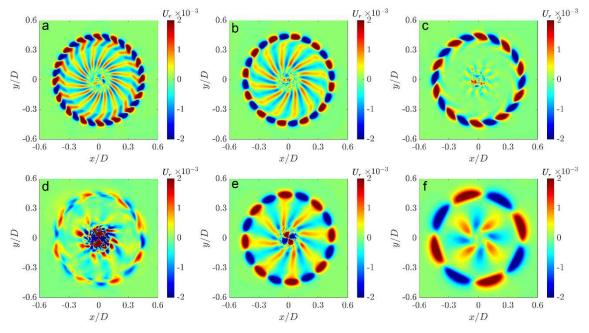
Fig. 18. The first six modes of pi-SPDMD for (a) mode 1,  $f/f_{bp}=4$ , (b) mode 2,  $f/f_{bp}=3$ , (c) mode 3,  $f/f_{bp}=2.5$ , (d) mode 4,  $f/f_{bp}=2$ , (e) mode 5,  $f/f_{bp}=2$ , (f) mode 6,  $f/f_{bp}=1$
